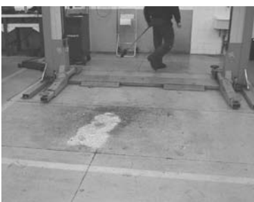
Uso de absorbentes para derrames
