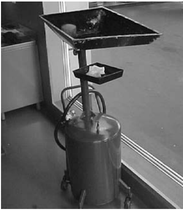
Sistema de recepción y almacenamiento de aceite lubricante usado y drenaje de filtros
