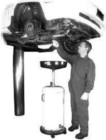
Recepción y almacenamiento de aceite lubricante usado y drenaje de filtros
